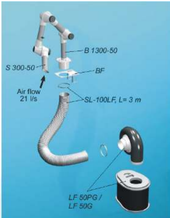
LFK 150-ideálny systém pre samostatné pracovisko, priemer ramena 50 mm.
