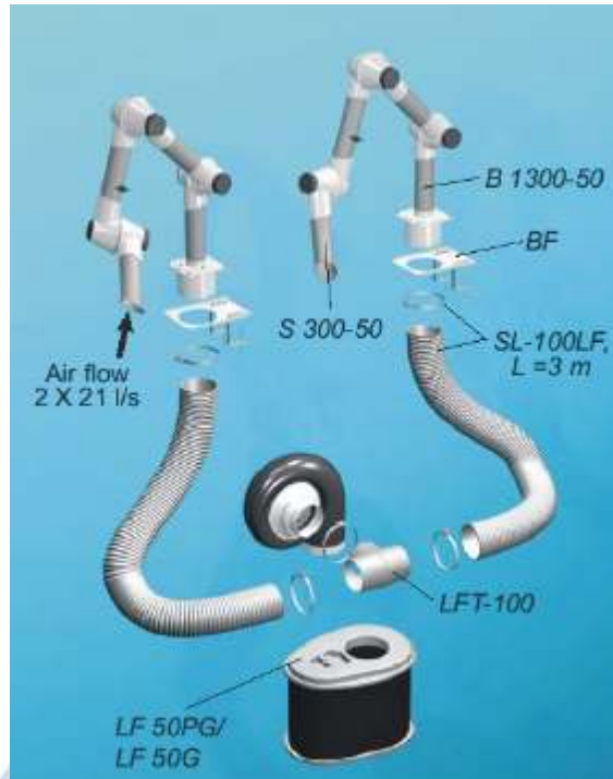
LFK 250 – systém dvoch ramien so spojovacími dielcami a konzolou, priemer ramena 50mm
